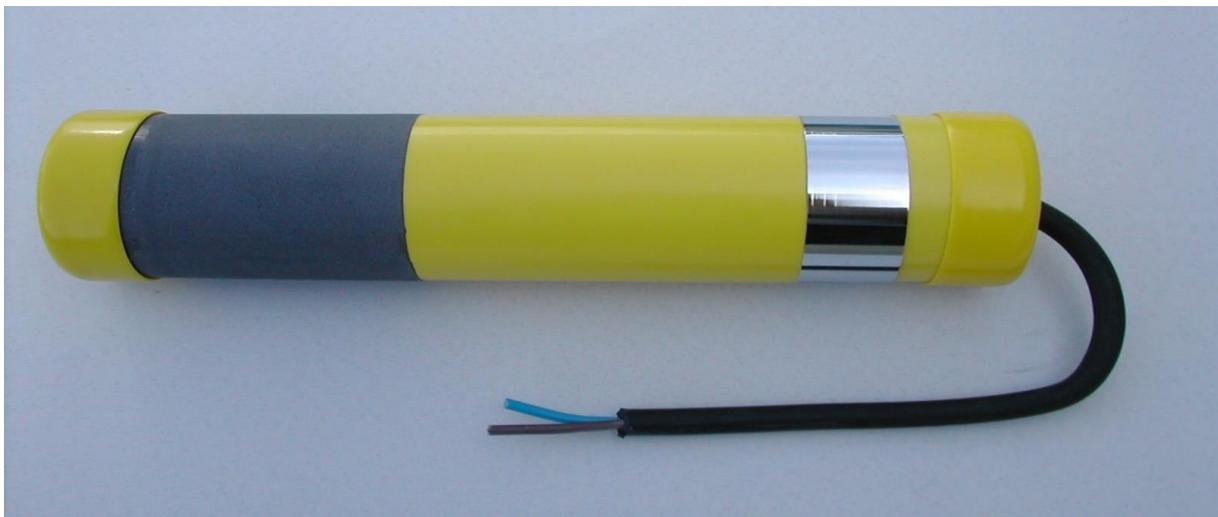
Cette électrode permanente avec coupon permet d'effectuer des mesures « OFF » sans interrompre le redresseur. Coupons standards de 50 cm<sup>2</sup> et 10 cm<sup>2</sup>, autres surfaces sur demande. La CELCO 7 C50 est équipée d'une membrane pour empêcher la contamination du coupon par le sulfate de cuivre.
